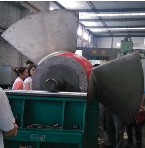
图31 转子部件静平衡图
