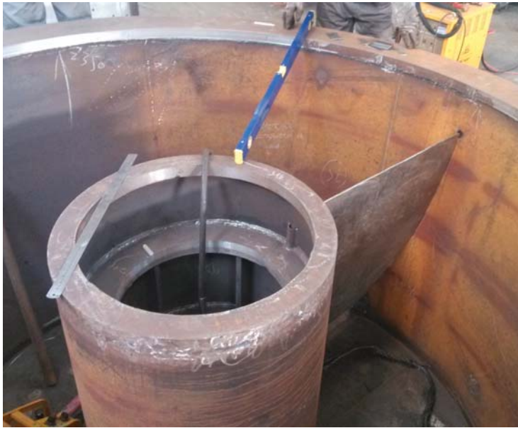
图22 导叶体焊接校正放样
