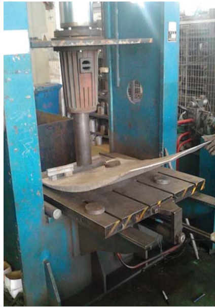
图21 导叶片进行整形
