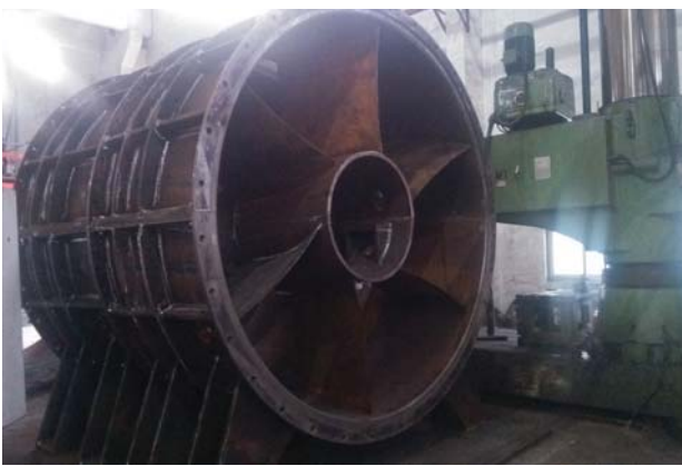
图24 加工好的导叶体
