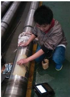
图26 泵轴超声波探伤
