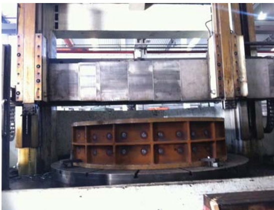
图19 加工中的叶轮室
