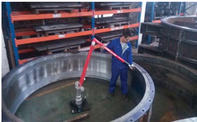
图20 关节臂检测叶轮室内球面
