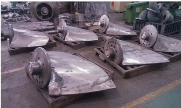
图14 加工完毕的部分叶片
