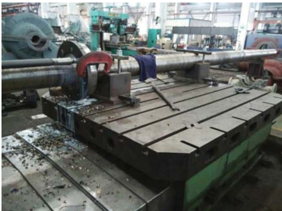
图27 泵轴法兰端镗孔
