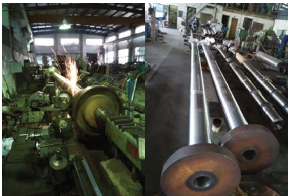
图25 泵轴磨削中和粗加工完毕后
