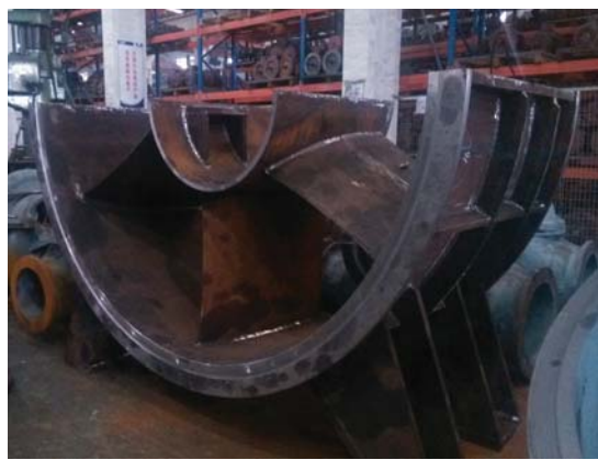
图23 加工好的导叶体下半部分
