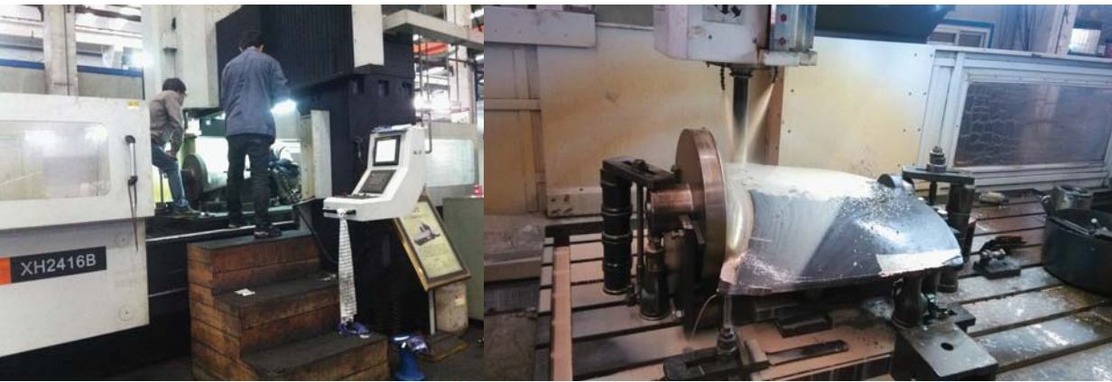
图13 数控加工中心叶片加工图
