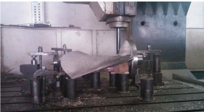
图7 数控加工中心叶片模具加工图
