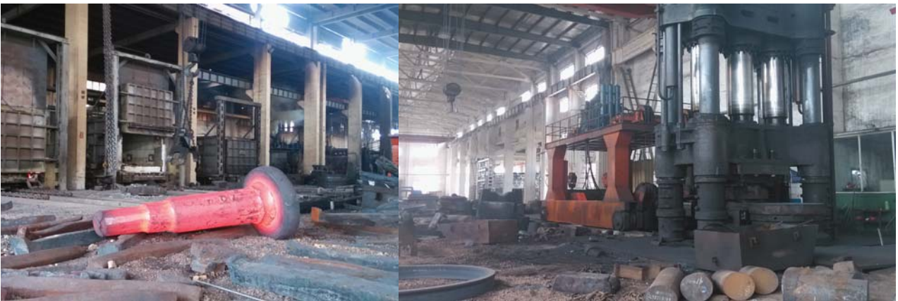
图9 泵轴采用优质锻钢成型
